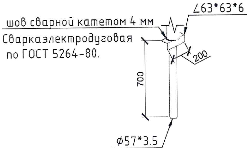
Рис. 3. Монтаж на металлические закладные
