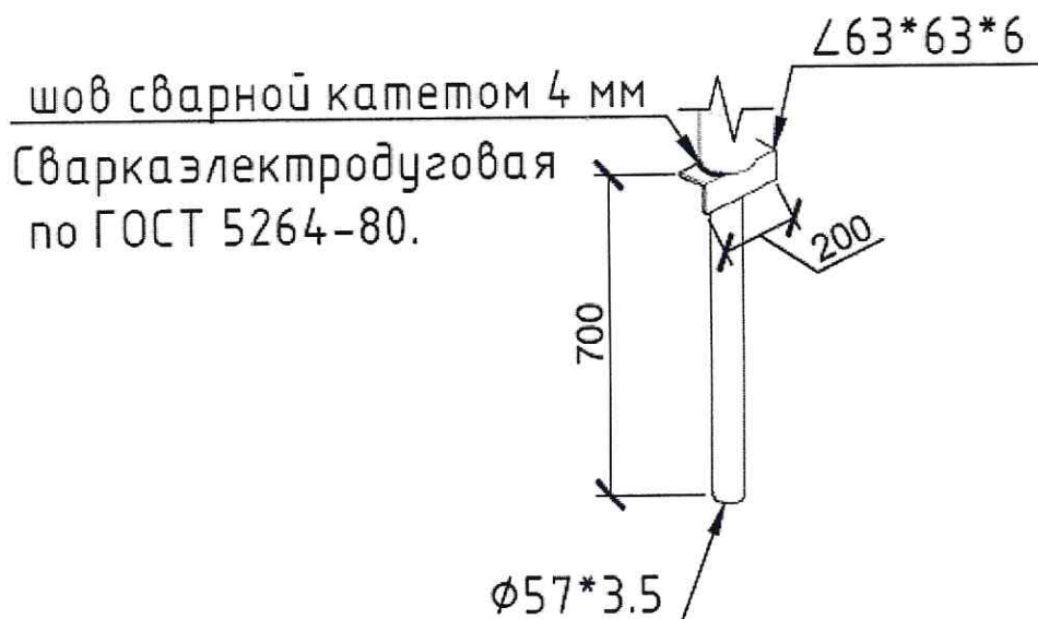
Рис. 3. Крепление на металлические закладные
